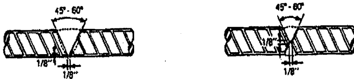
รูปที่ 1 การเชื่อมชนของเหล็กข้ออ้อย [2] แบบร่องรูปอักษร V
